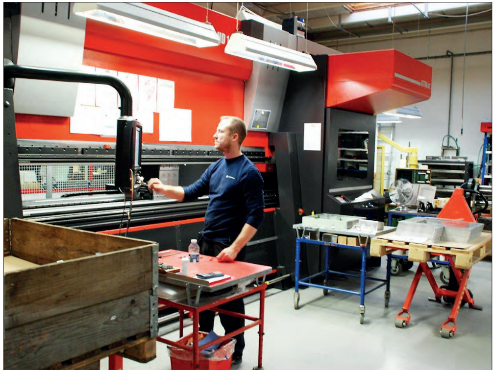
Amada-kantpressen med automatisk værktøjsveksler har fordoblet produktionen hos Glostrup-virksomheden Hougaard & Koefoed.
